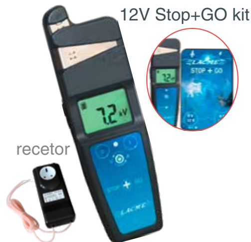
STOP + GO 3 EM 1 Ferramenta universal para ligar/desligar qualquer eletrificador de rede até uma distância de 30km por simples contato com o cercado (superfície de contacto adaptada para fios e fitas). Visualização da tensão (kV), intensidade da corrente (A) e direção da corrente para uma fácil deteção das falhas. Controlo do impulso do cercado. Botão On/ Off. Um controlo remoto pode controlar vários eletrificadores de rede, ou vários controlos remotos podem controlar só um aparelho.
